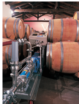
Serie MAE con tablero electrónico de control para boqueroles de barricas
