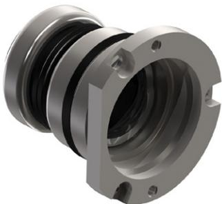
La garniture mécanique simple est de type à cartouche hygiénique équilibrée et elle représente l'exécution de base pour des applications à basse vitesse de rotation et/ou en présence de produits non visqueux.
