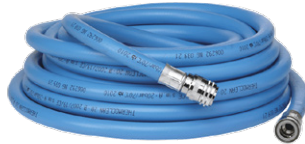
TUYAU DE CAOUTCHOUC VAPEUR Pression de travail 10 Bar à 120°C Pression d'explosion 30 Bar à 120°C Plage de température -30°/+120° 3/4" (Ø 19x31) - 1" (Ø 25x37)
