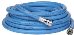
DAMPFSCHLAUCH AUS GUMMI Arbeitsdruck 10 Bar bei 120°C Explosionsdruck 30 Bar bei 120°C Temperaturbereich -30°/+120° 3/4" (Ø 19x31) - 1" (Ø 25x37)
