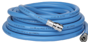
MANGUERA VAPOR Pres. de trabajo 10 Bar a 120°C Pres. de explosión 30 Bar a 120°C Rango de temperatura -30°/+120° 3/4" (Ø 19x31) - 1" (Ø 25x37) STEAM HOSE Working pressure 10 Bar at 120°C Explosion pressure 30 Bar at 120°C T range -30°/+120° 3/4" (Ø 19x31) - 1" (Ø 25x37)
